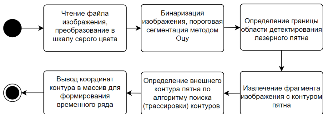
Рис. 2. Uml-диаграмма алгоритма определения координат контура лазерного пучка на экране реперного модуля
